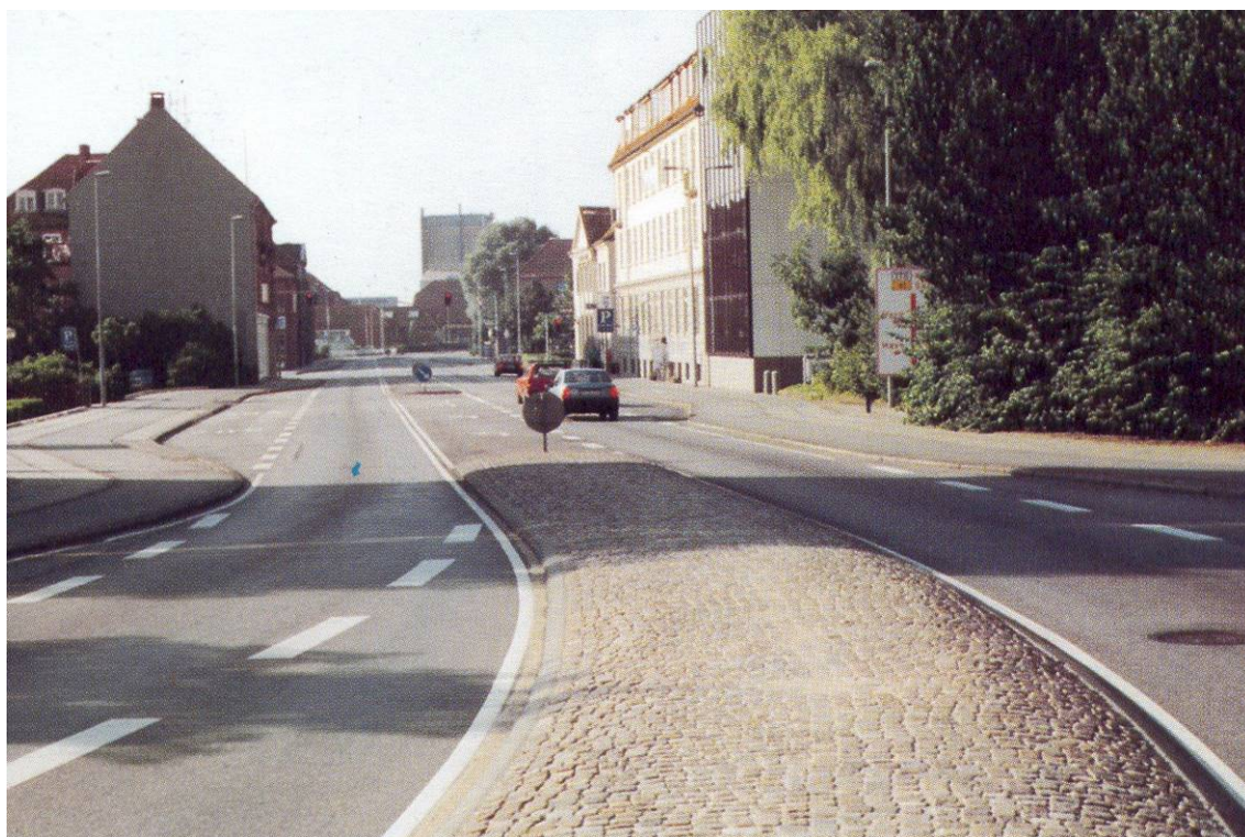
Obr. 7.33 Zúženie jazdných pruhov dlažbovým deliacim pásom
