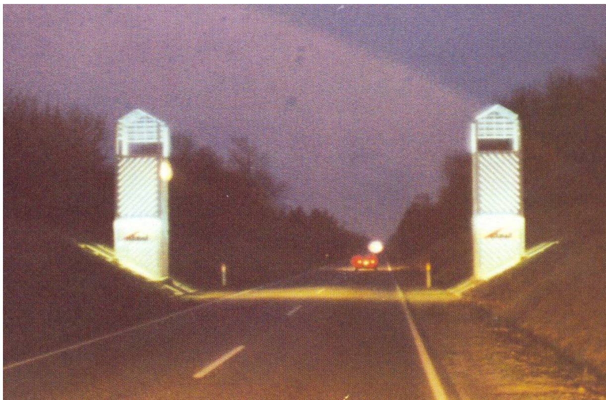
Obr. 7.25 Varovná signalizácia v kombinácii s posunom jazdného pruhu
