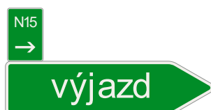
Obrázok 12: Umiestnenie Z 390 Náhradná trasa nad Z 374 Výjazdová tabuľa
