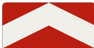
Obrázok 70: Osobitné vyobrazenie vodiacej tabule na čele tlmíča nárazov
