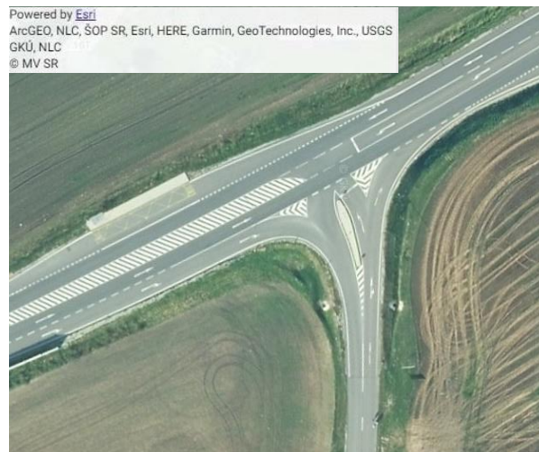
Obrázok 53 – Príklad riešenia križovatky s uhlom križovania \alpha < 75^\circ (Zdroj: https://zbgis.skgeodesy.sk )
