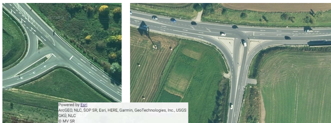
Obrázok 22 – Príklady stykovej križovatky s usmernením dopravných prúdov (Zdroj: https://zbqis.skgeodesy.sk )
