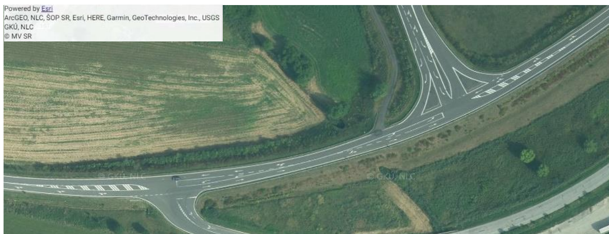
Obrázok 30 – Príklad riešenia odsadenej križovatky – prídavné pruhy na odbočenie vľavo sú medzi vedľajšími cestami (Zdroj: https://zbgis.skgeodesy.sk )
