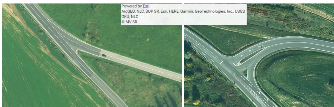
Obrázok 27 – Príklad neupravenej a upravenej vidlicovej križovatky (Zdroj: https://zbgis.skgeodesy.sk )
